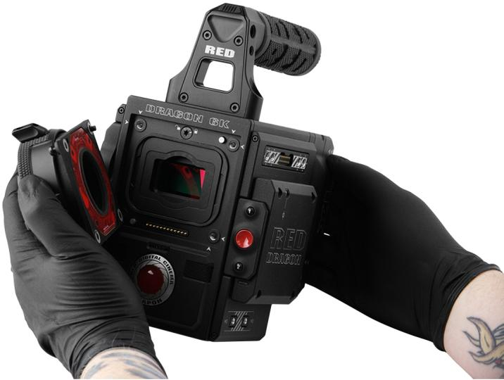
图：拆下镜头卡口
