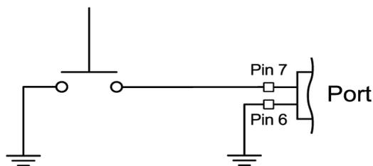
图：触点闭合式触发器按钮电路图
