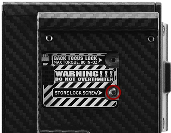
图：从储存锁定螺丝位置卸下螺丝
