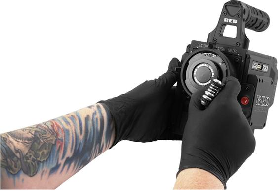
图：拆下镜头卡口螺丝
