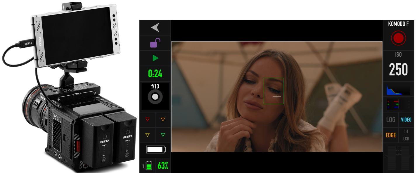
Figure: KOMODO Link-Adapter verbunden mit einem Android-Telefon mit RED Control
