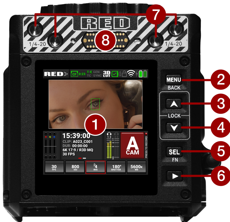
Figure: Bedienelemente und Funktionen des Kameragehäuses oben
