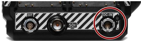
Connectez la fiche de l'adaptateur d'alimentation CC ODU 0B à 2 broches à ce port pour fournir à la caméra une alimentation CC continue. L'adaptateur d'alimentation RED fournit une alimentation CC pour faire fonctionner la caméra et recharger le **Batteries**.
