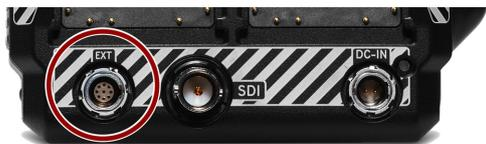
Le port d'extension ODU 0B à 9 broches prend en charge RS-232 RX, RS-232 TX et un déclencheur d'entrée à usage général (GPI) (fermeture de commutateur actif-bas), sortie à usage général (GPO), code temporel et Genlock. Le connecteur offre également une alimentation auxiliaire de 5 volts, avec une consommation de courant soutenue maximale de 500 mA.
