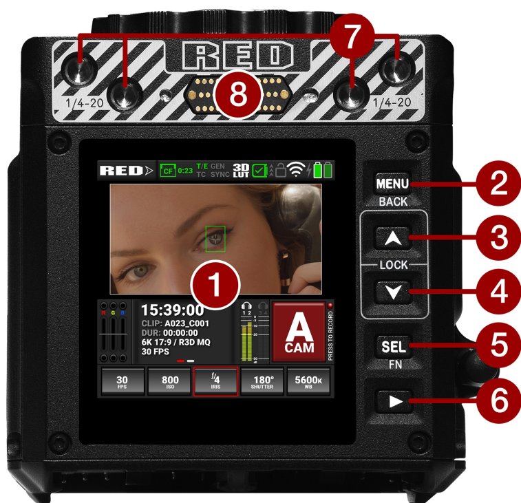
Figure: カメラボディ上部の操作部と機能
