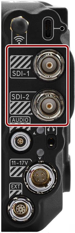
Figure : 12G-SDI公头BNC连接器的正面(看着摄像机的背面)。
