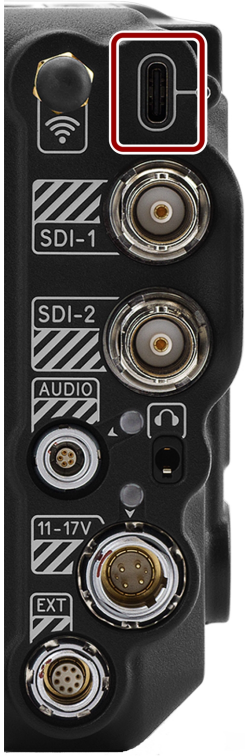
Figure: USB-C 端口的正面( 看着相机的背面)。
