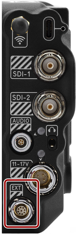
Figure: 雌性 9 触点扩展端口的正面 (看着相机的背面)。
