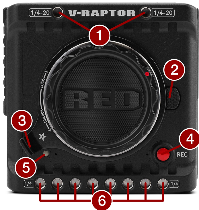
Figure: 相机机身前部控制和功能
