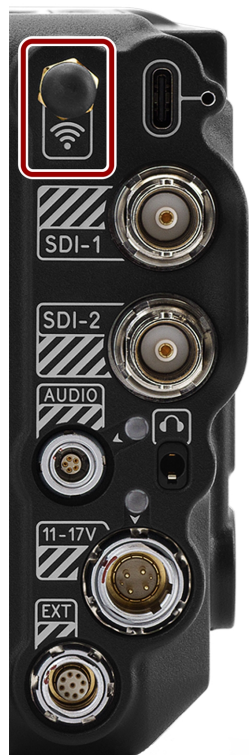
Figure: RP SMA母口的正面(看着相机的背面)。
