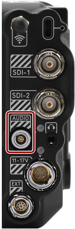
Figura: Cara frontal del conector de audio 00B hembra de 5 patillas (mirando a la parte posterior de la cámara).
