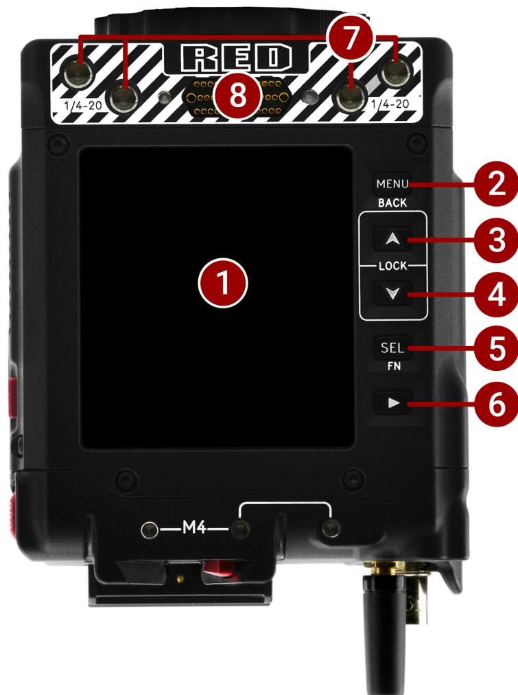
Figura: Controles y características de la parte superior del cuerpo de la cámara
