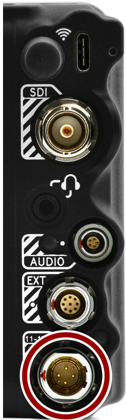
フィギュア: オスの6ピン1B DC電源入力コネクタの前面(カメラの背面を見る)。
