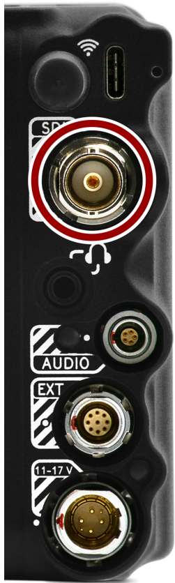
Figure : 12G-SDI公头BNC连接器的正面(看着摄像机的背面)。
