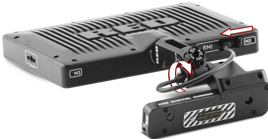
**注意:** RMI 电缆以一个角度连接到显示器上, 如图所示。USB-C 风格的 DSMC3™ RMI 电缆是一种定制的 Pinned 电缆, 与标准的 USB-C 电缆端口 (包括后置摄像头 USB-C 端口) 不兼容。RMI 上的 EXP 端口是为了将来使用, 目前不支持。
