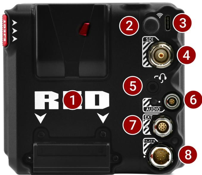
Figure: 相机机身后部控制和功能
