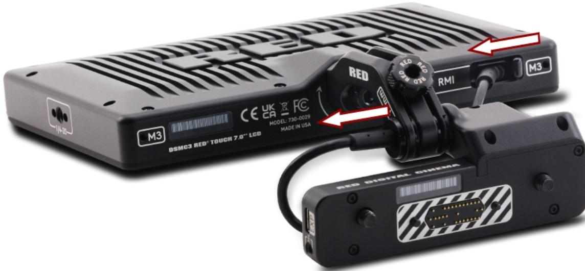
**注意：**RMI电缆以一个角度连接到显示器上，如图所示。USB-C风格的DSMC3™RMI电缆是一种定制的Pinned电缆，与标准的USB-C电缆端口(包括后置摄像头USB-C端口)不兼容。RMI上的EXP端口是为了将来使用，目前不支持。
