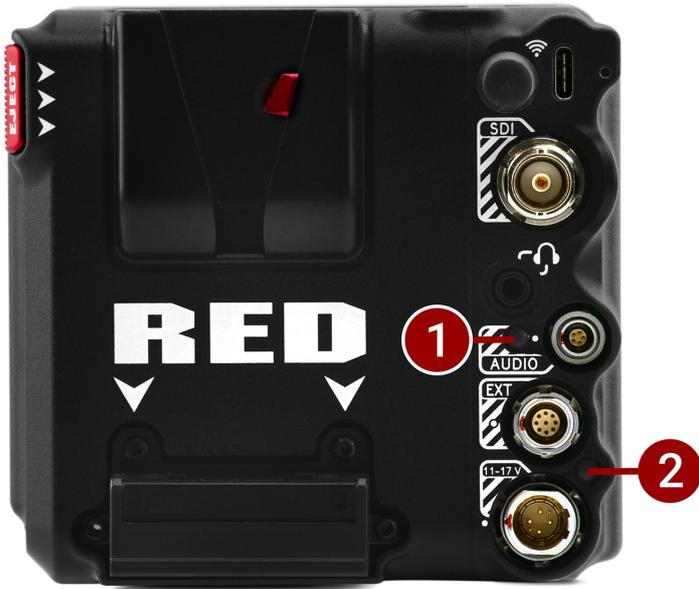
Figure : 摄像机LED, 后部
