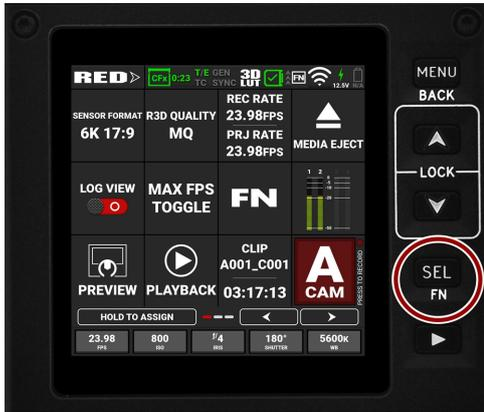
6. 每次按 SEL (FN) 键时, 摄像机都会高亮显示 SDI 叠加图上的最高值, 并循环显示下一个值:
