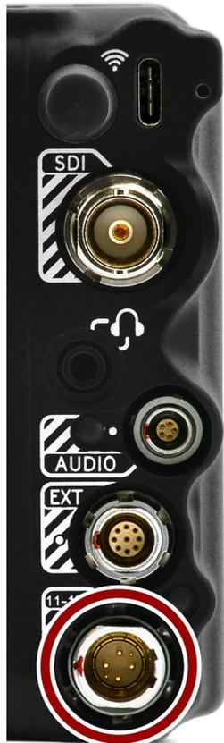
雄性6针1B DC-IN连接器接受从11 V DC到17 V DC的直流输入电源。一个内置的电源调节器可防止反向极性连接、静电放电(ESD)、欠压、过压和过流。
