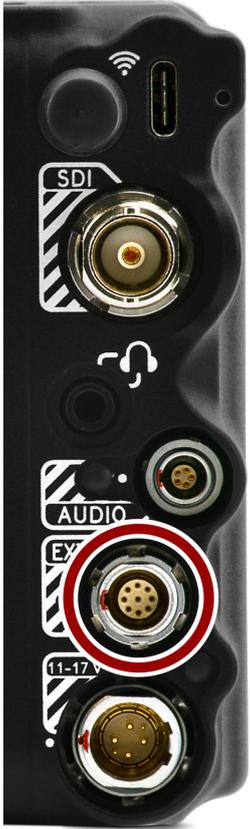
雌性9触点0B ODU扩展端口支持串行 (RS-232 RX和TX)、通用输入 (GPI) 触发器 (低电平开关闭合)、通用输出 (GPO)、时间码和基因锁。该连接器还提供辅助的5伏电源输出, 最大持续电流为500毫安。
