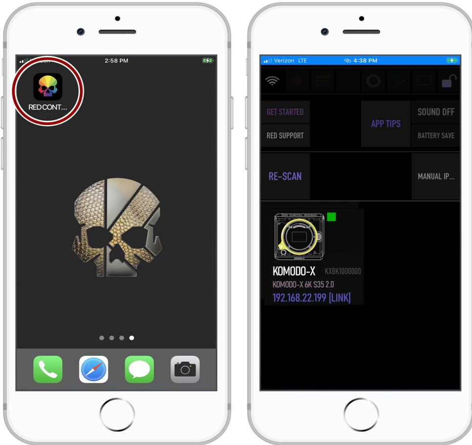
RED控制应用程序显示相机连接图标。在IP地址后面可以看到LINK这个词。
