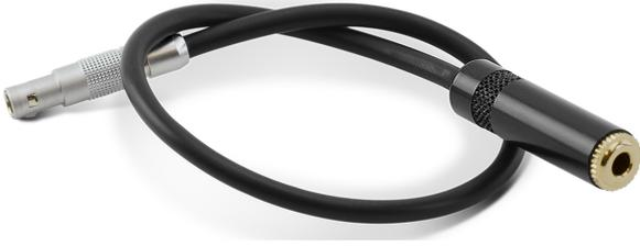
DSMC3™ RED® 5 针至单个 3.5 毫米适配器是一条 11.3 英寸 (28.9 厘米) 电缆, 设计用于将 5 针音频端口分离为单个 3.5 毫米 TRS 输入, 以便连接 3.5 毫米音频设备。
