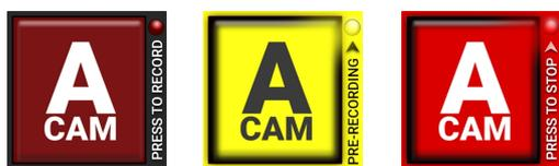
机载 液晶触摸屏预览页面上的 "摄像机名称和记录" 按钮会显示分配给摄像机的摄像机字母 (请参阅 **石板** 和 **摄像机 ID**)。你可以点击这个区域来开始预录，并开始和停止录制。
