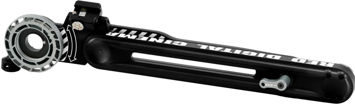
RED® 设计的 RED® EVF 延伸臂可无缝连接到 RED® EVF 支架上, 当操作员在三脚架或推车上使用摄像机时, 可为 RED® Compact EVF 和 DSMC2® RED® EVF (OLED) 提供更大的可调范围和配置。延伸臂完全伸展时的范围为 10 至 15 英寸(25 至 37 厘米), 支持使用 EL-3 型安装方式的标准目镜水平仪。
