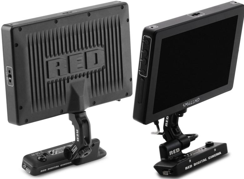
可选的 DSMC3™ RED Touch 7.0 英寸液晶显示屏为录制和查看 KOMODO-X 摄像机的镜头提供了高清观看体验。1920 x 1200分辨率的显示面板具有1300尼特的峰值亮度和高像素密度(322 ppi)，不仅在观看录像时提供最佳体验，而且还具有100%的DCI-P3色域覆盖率，以实现巨大的色彩准确性。
