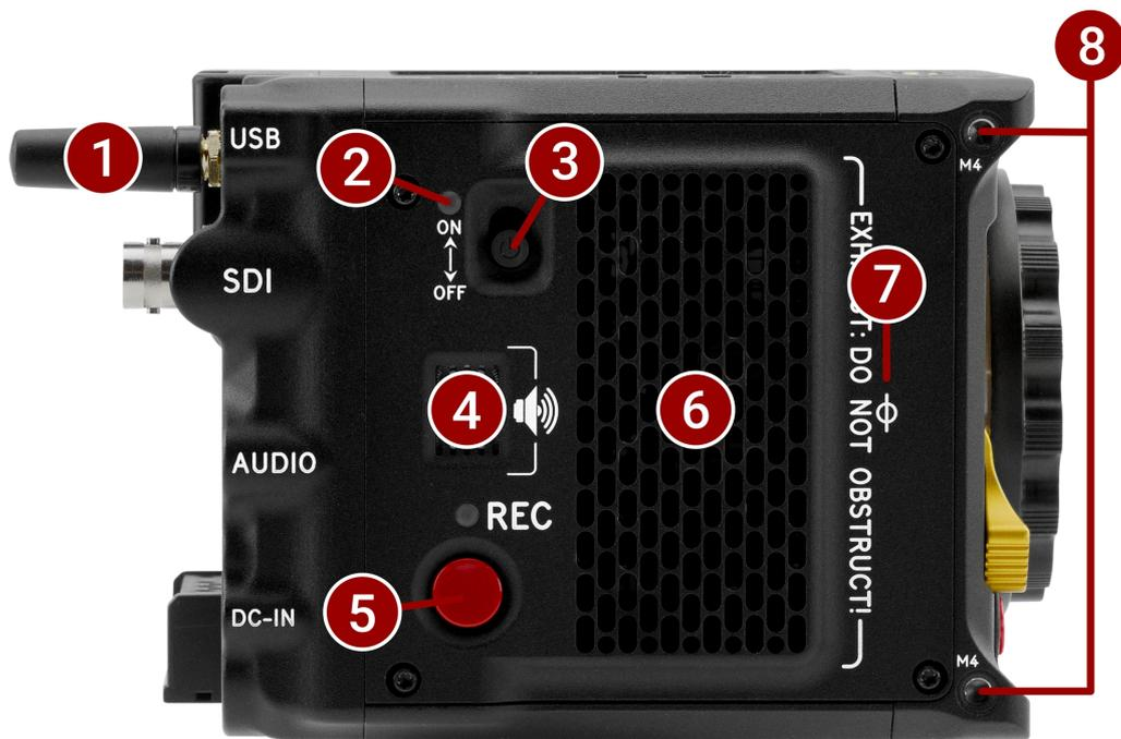
Figure: 相机机身右侧的控制和功能
