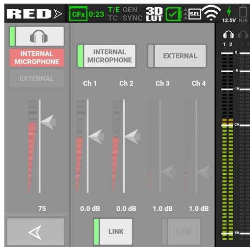
随着输入的增加,电平指示器从绿色到黄色到橙色到红色。当音频输入被夹住时,VU表顶部的通道号码变成红色。
