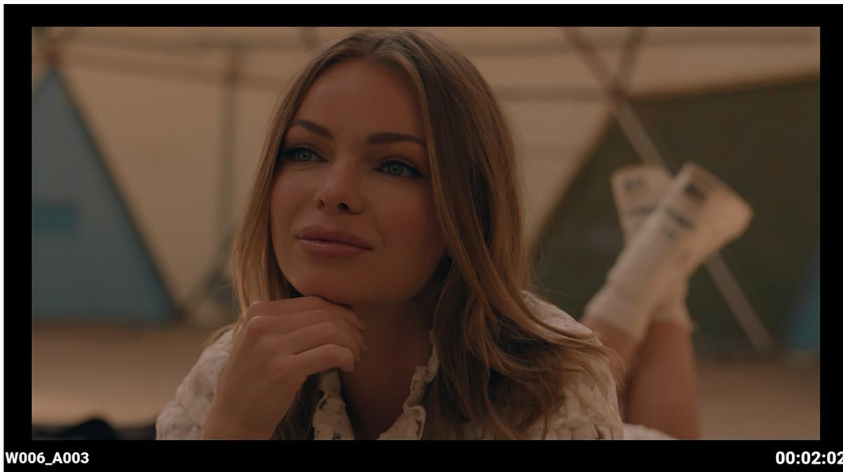
简单模式显示剪辑名称和当前时间码。当相机正在拍摄时，时间码变成红色，右上角出现一个红点。
