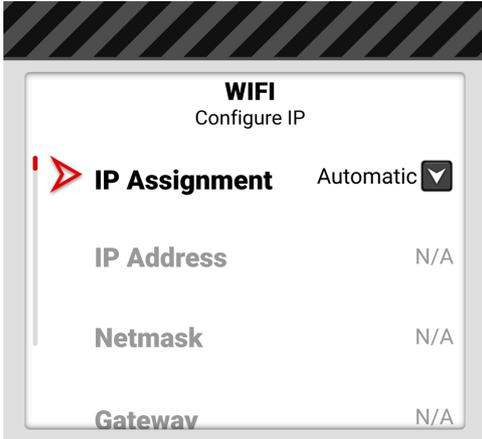
您可以使用配置 IP 页面选择 IP 分配模式, 并在手动模式下手动输入 IP、掩码和网关地址。
