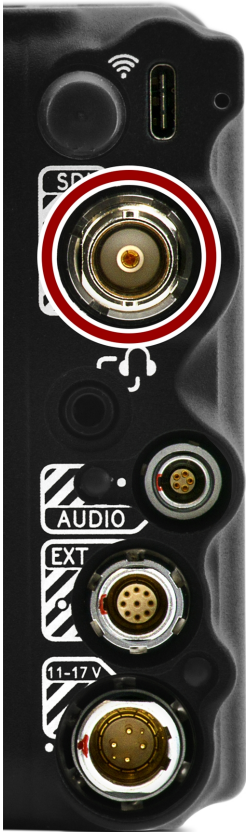
CF:图:12G-SDI公头BNC连接器的正面(看着摄像机的背面)。
