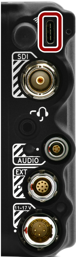
CF:图:USB-C端口的正面( 看着相机的背面) 。
