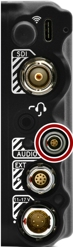
CF: 图: 雌性5针00B音频连接器的正面( 看着相机的背面) 。
