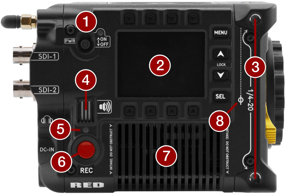
Figure : 相机机身右侧的控制和功能
