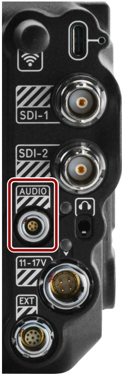
Figure : 雌性 5 针 00B 音频连接器的正面( 看着相机的背面) 。
