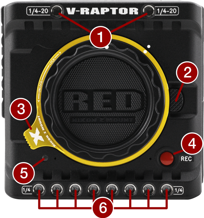
Figure : 相机机身前部控制和功能
