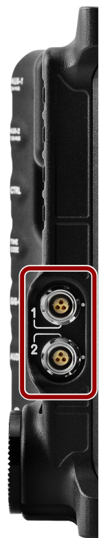
CF: 图: 费舍尔母接头的正面( 看着相机的正面) 。
