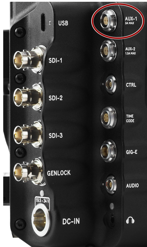
CF：图：AUX-1母接头的正面( 看着相机的背面) 。
