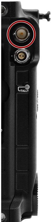
CF:图:EVF公头BNC连接器的前脸( 看着相机的前面) 。
