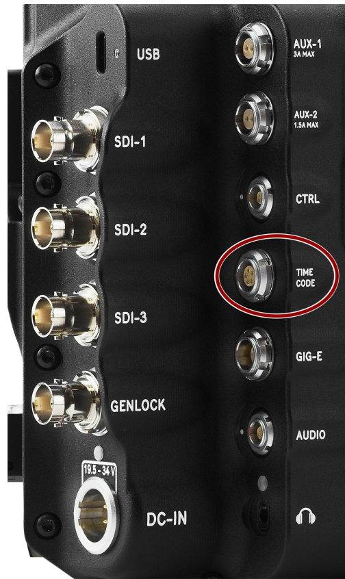
CF: 图:时间码0B连接器的正面( 看着摄像机的背面) 。
