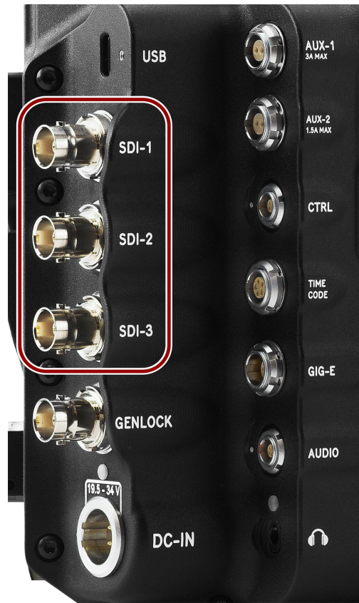
CF:图:12G SDI公头BNC连接器的正面( 看着摄像机的背面) 。
