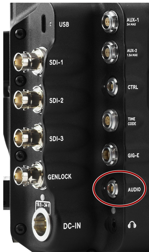
CF：图：雌性5针00B音频连接器的正面( 看着相机的背面) 。
