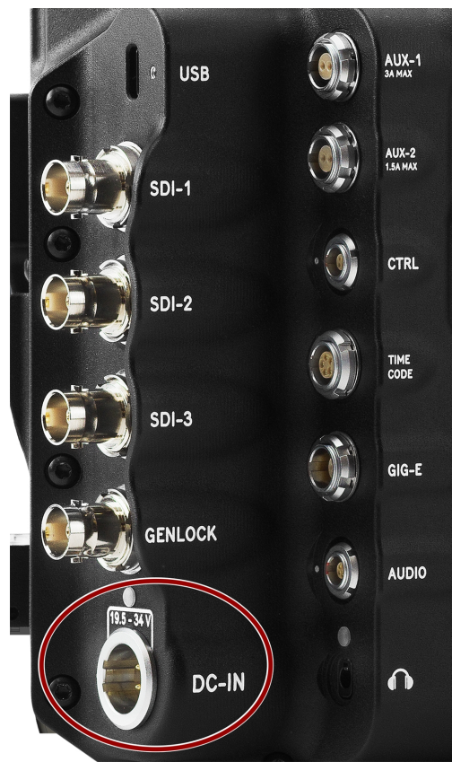
CF: 图: 雄性DC-IN电源输入连接器的正面( 看着相机的背面) 。
