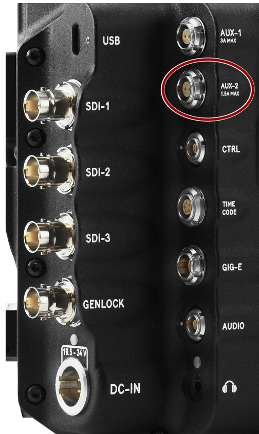
CF：图：AUX-2母接头的正面( 看着相机的背面) 。
