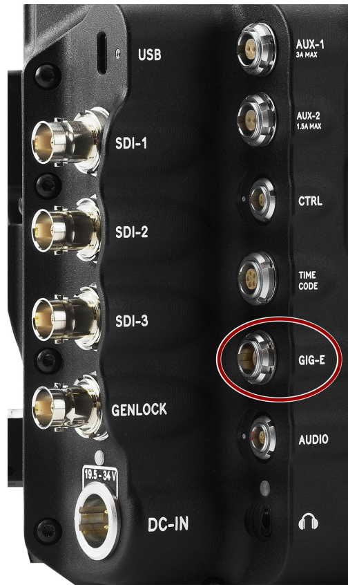
CF: 图:GIG-E连接器的正面( 看着相机的背面) 。
