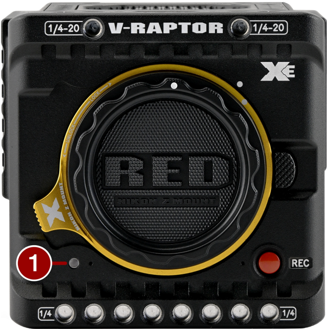
CF:图:前置摄像头LED
