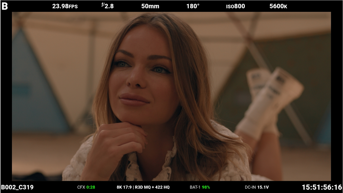
CF:图:启用SDI标准叠加模式的SDI显示器
